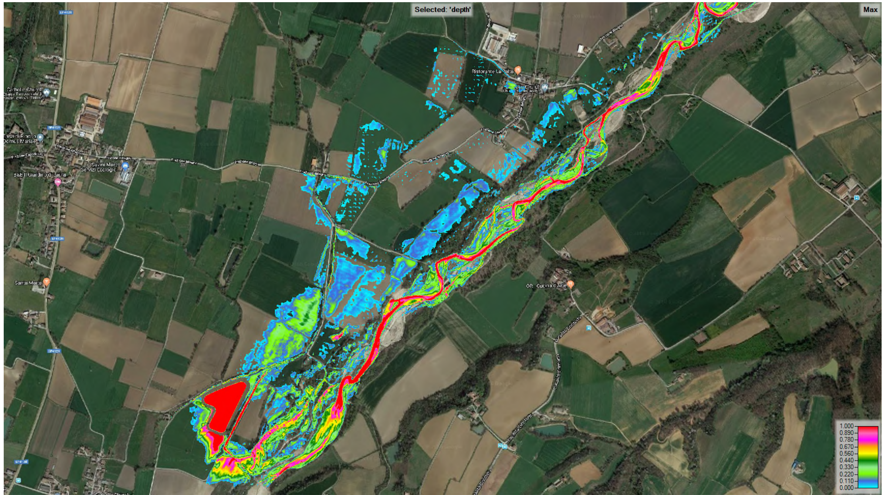
SCENARIO 7 - Simulazione di Dam Break (fenomeno di Piping dell'arginatura sud) – tiranti idrici massimi (m)
